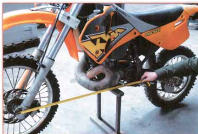
• Al livello dell'interasse, tra i pemi ruota l'escursione si amplifica fino a circa 100 mm.
